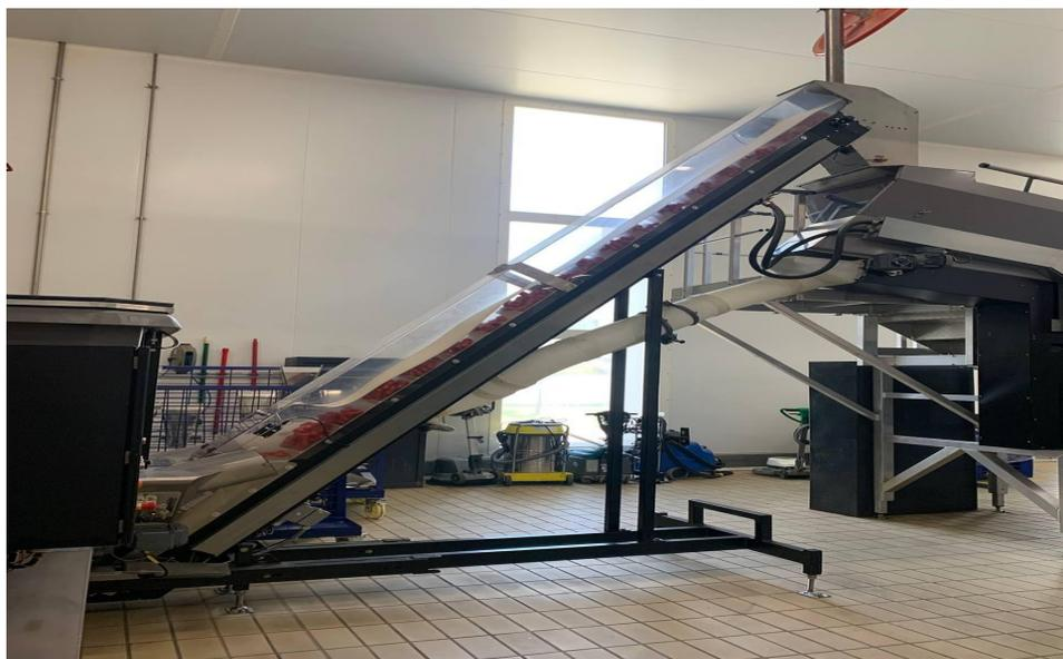
**Figure 1.5** Alimentateur de préformes.
