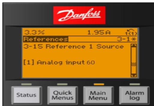
Figure 2.41 Configuration de l'entre analogique.
