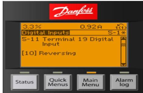
**Figure 2.43** Configuration pour le sens inverse du moteur.
