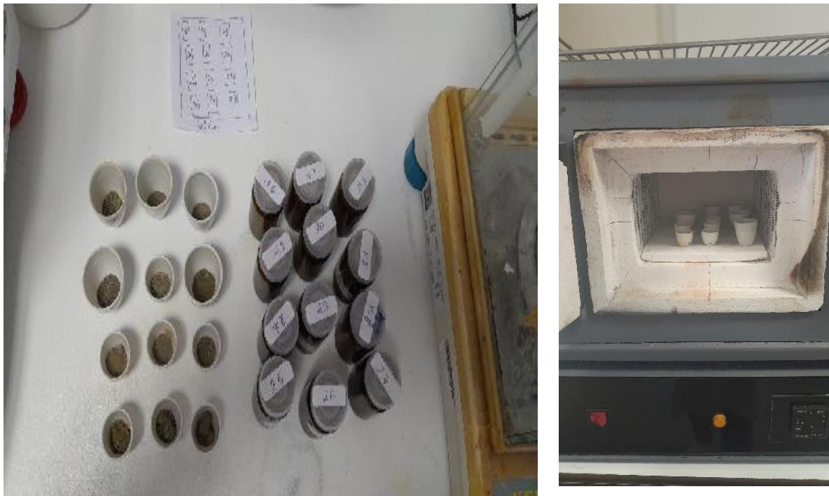
Figure III-3 : Photos numériques des échantillons et du four à moufle utilisé pour l'analyse de la matière organique (MO) des sédiments
