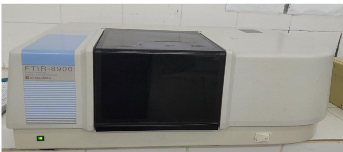
Figure III-4 : IRTFFTR utilisée pour la caractérisation des sédiments et des plastiques identifiés
