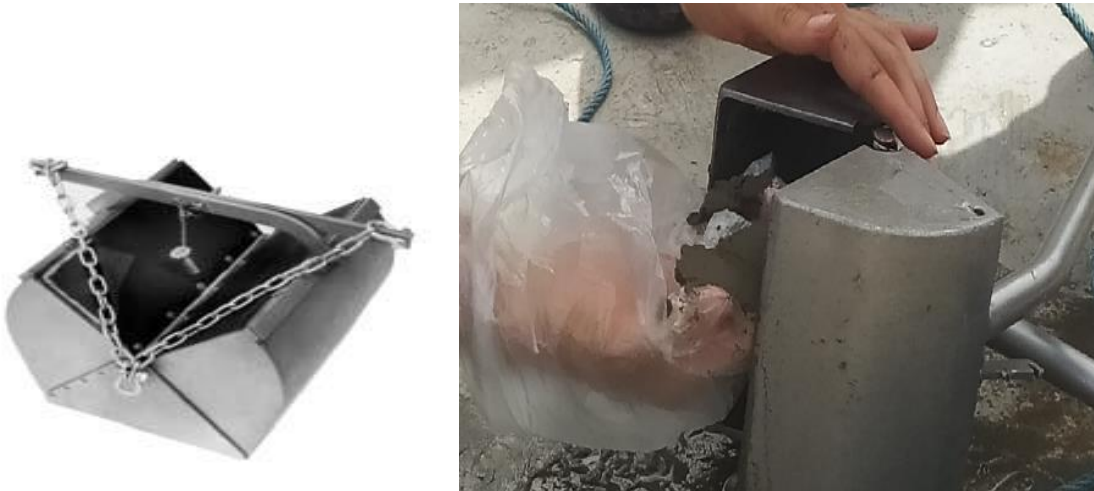
Figure III-1 : Benne Van Veen utilisé pour le prélèvement des sédiments
