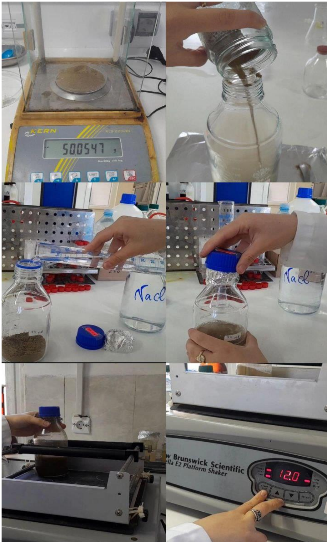
Figure III-6 : Différentes étapes faites pour l'extraction des MPs en utilisant la solution saturée en NaCl avec sédiments
