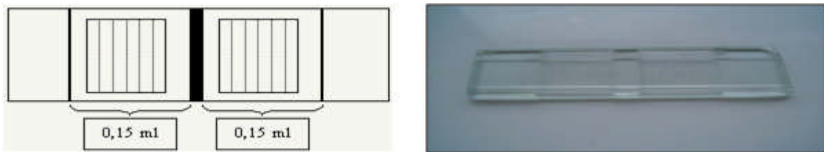
Figure 9 : Schéma et photographie d'une lame de Mac Master
