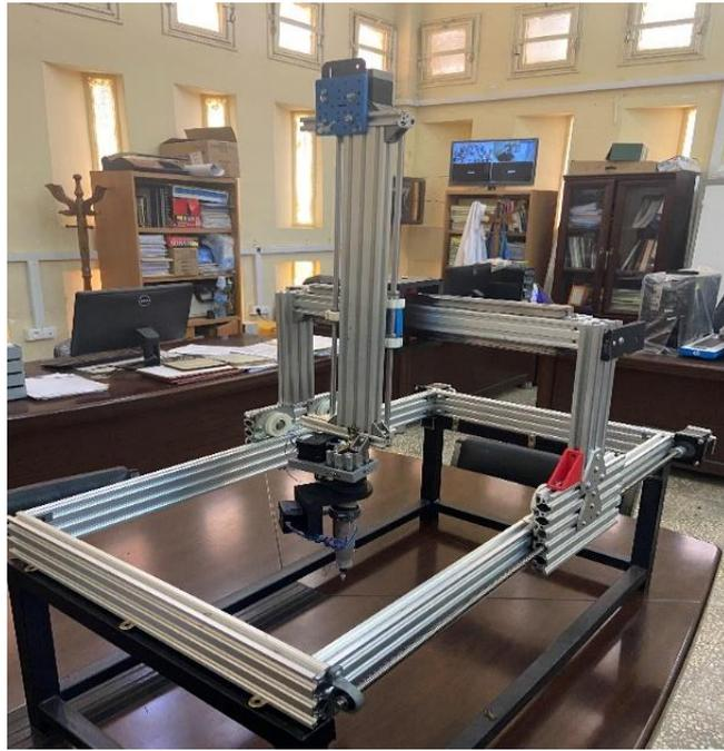
Figure 31 : Assemblage complet de la machine
