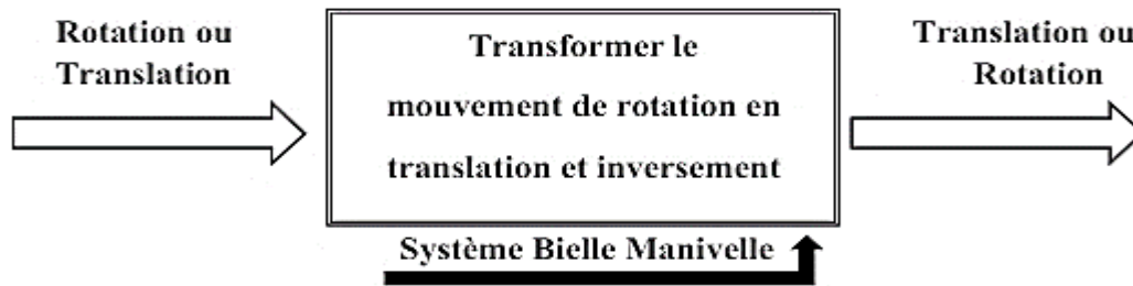
Figure II.4 : La fonction du système bielle manivelle.[9]
