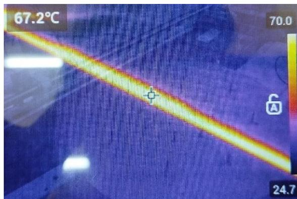
**Figure 3.25** : température de fil dans 2<sup>ème</sup> essai.
