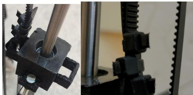
**Figure 4.11** : Mécanisme de guidage de l'axe Z.
