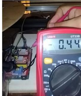
**Figure 4.15** : réglage de driver A4988.
