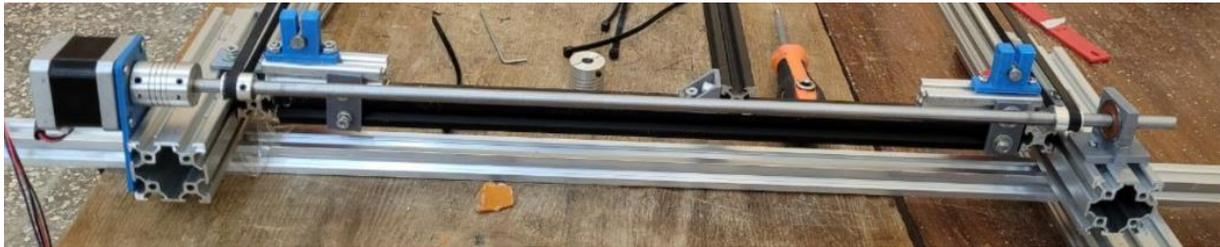
**Figure 4.8** : système de motorisation de l'axe X.
