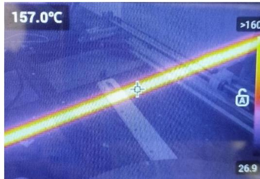
**Figure 3.24** : température de fil dans le 1<sup>er</sup> essai.
