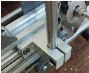
**Figure 4.6 :** installation de la tige de l'axe Z.
