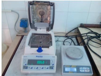
Figure n° 7 : Dessiccateur et balance analytique.
