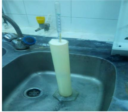
**Figure n° 6** : Lactodensimètre et éprouvette.
