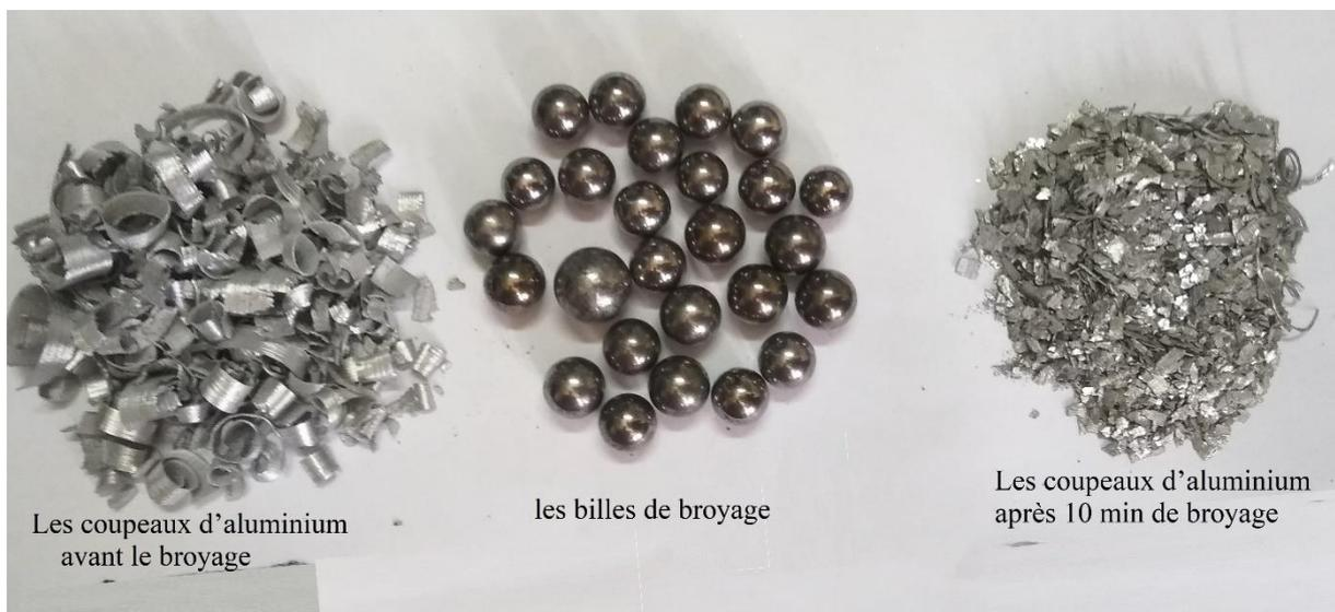
Figure 24. Un échantillon de copeaux d'aluminium avant et après broyage à billes
