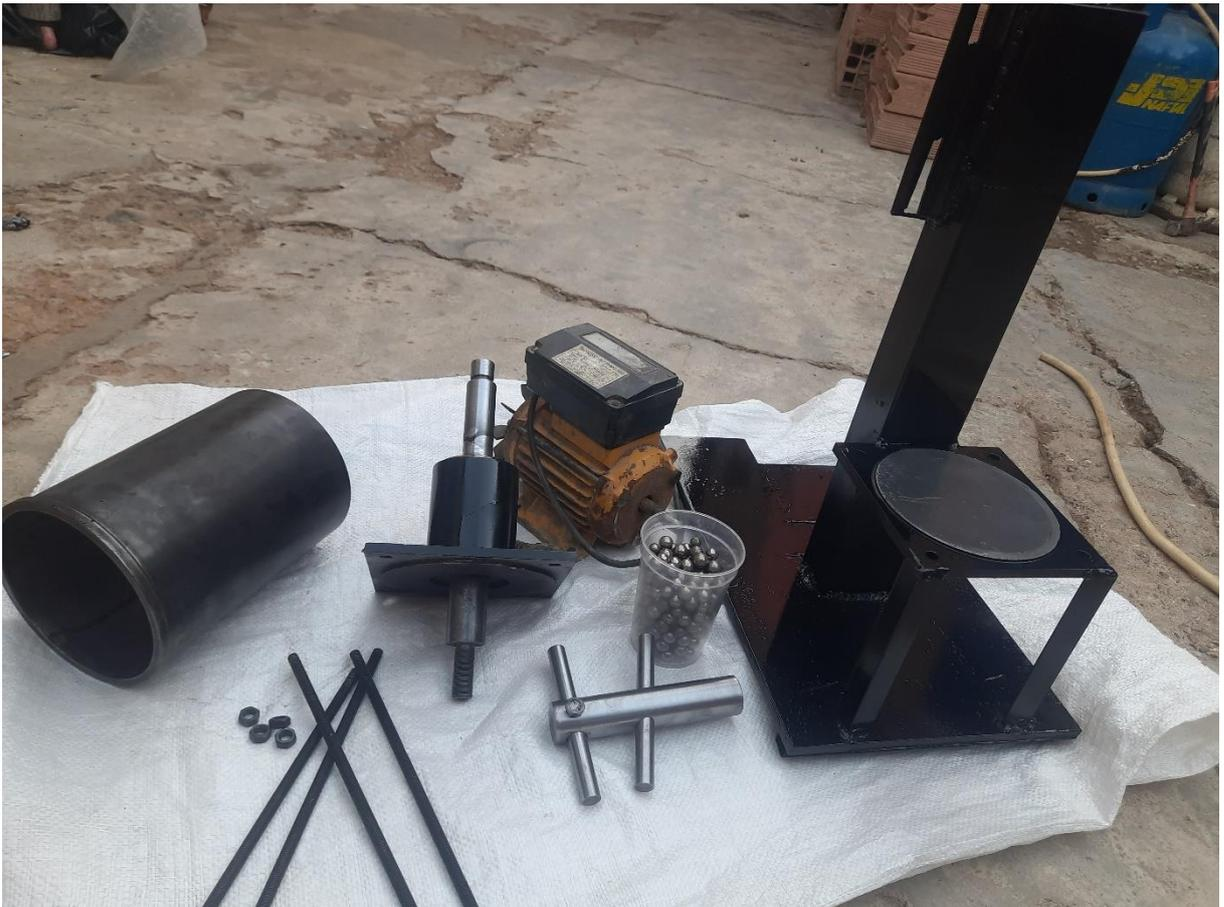
Figure7 . broyeur démontée
