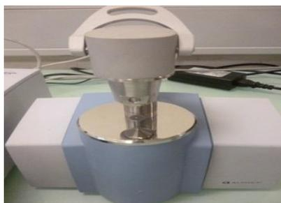
**Figure 2.3** Appareil de FTIR (ALPHA)
