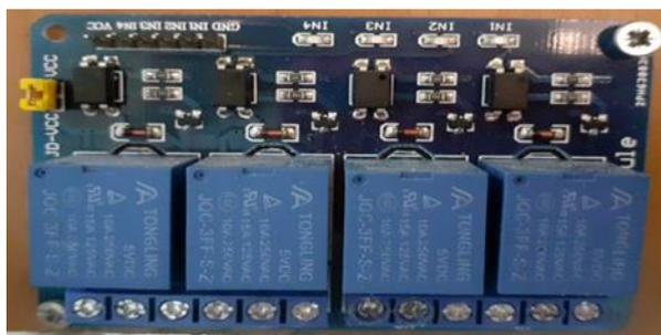
**Figure IV. 17:** module de relais à 4 canaux avec accouplement léger 5V
