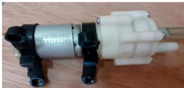
**Figure IV. 22:** Pompe à eau DC 12V.
