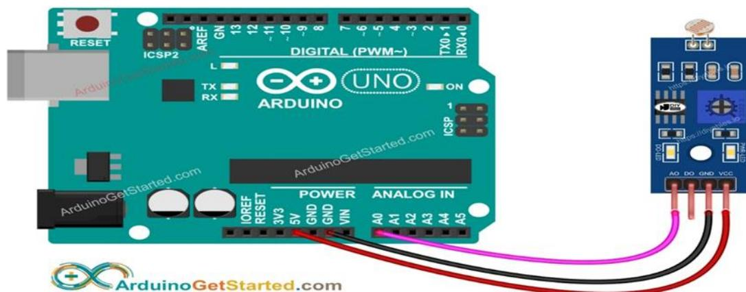
Figure III. 28: Photo de capteur de LDR(LM393) avec la carte arduino.
