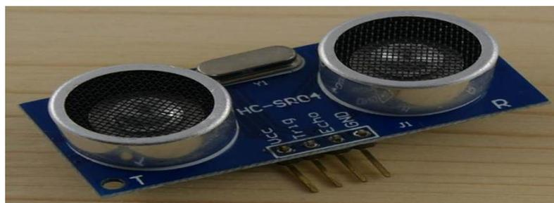
Figure III. 13: Photo de capteur de distance ultrasonique : HC-SR04.
