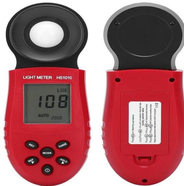
Figure (IV-6) : Digital luxmètre
