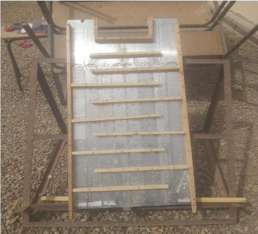
Figure (IV- 10) : Chauffe- air en aluminium
