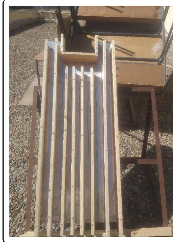
Figure (IV-5) : le capteur solaire a air on aluminium réalisé
