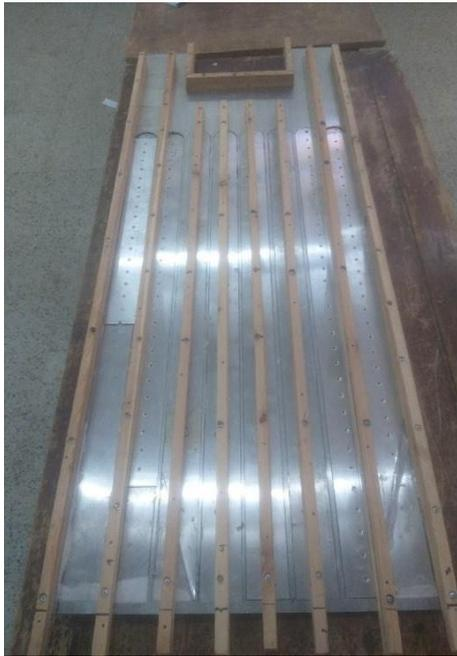
Figure (IV-1) : Le capteur solaire a air on aluminium réalisé
