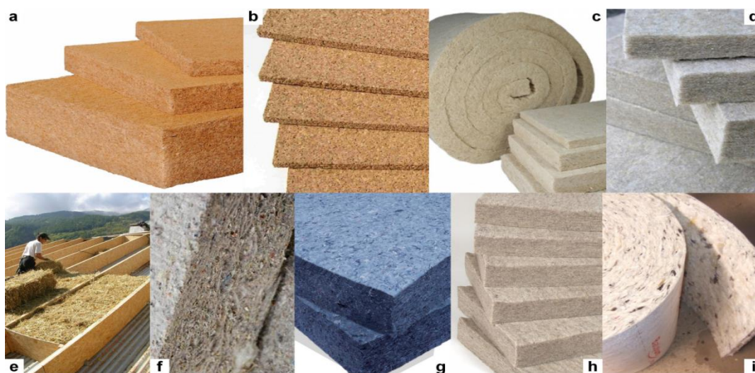
Figure VI: Isolants naturels : (a) Panneaux de fibre de bois, (b) Panneaux de liège, (c) Panneaux et rouleau de laine de chanvre, (d) Panneaux de laine de lin, (e) Bottes de pailles, (f) Panneaux de ouate de cellulose issue du recyclage du papier, (g) Panneaux de ouate de cellulose issue du recyclage.
