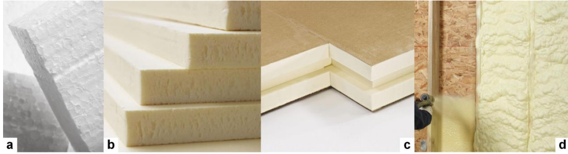
Figure V: Isolants synthétiques : (a) Polystyrène expansé (PSE), (b) Polystyrène extrudé (XPS), (c) Plaques de polyuréthane et (d) Polyuréthane projeté.
