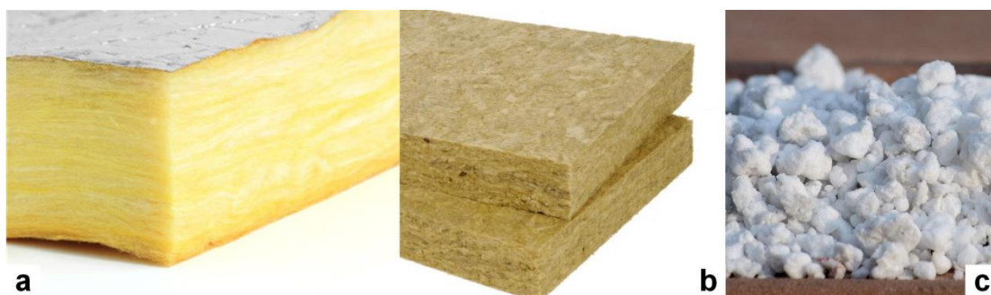
Figure IV: Isolants minéraux : (a) Laine de verre, (b) Laine de roche et (c) Perlite.[5]
