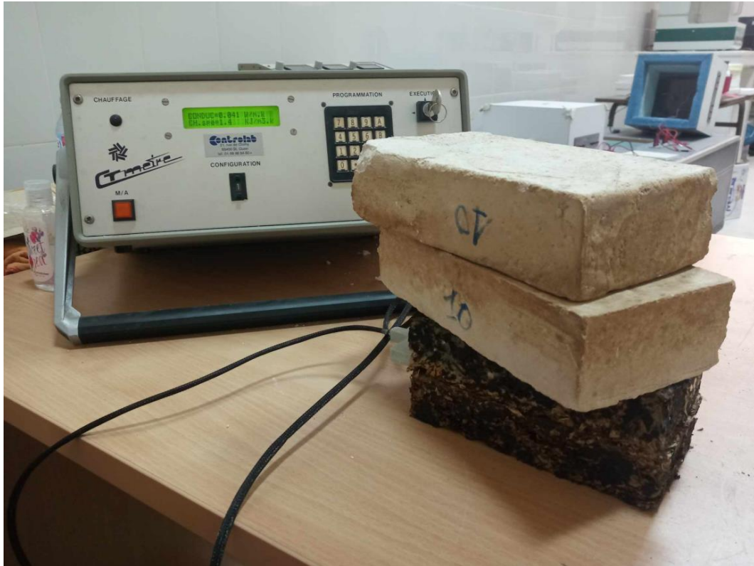
Figure XXII: mesure de la conductivité avec la méthode du fil chaud.
