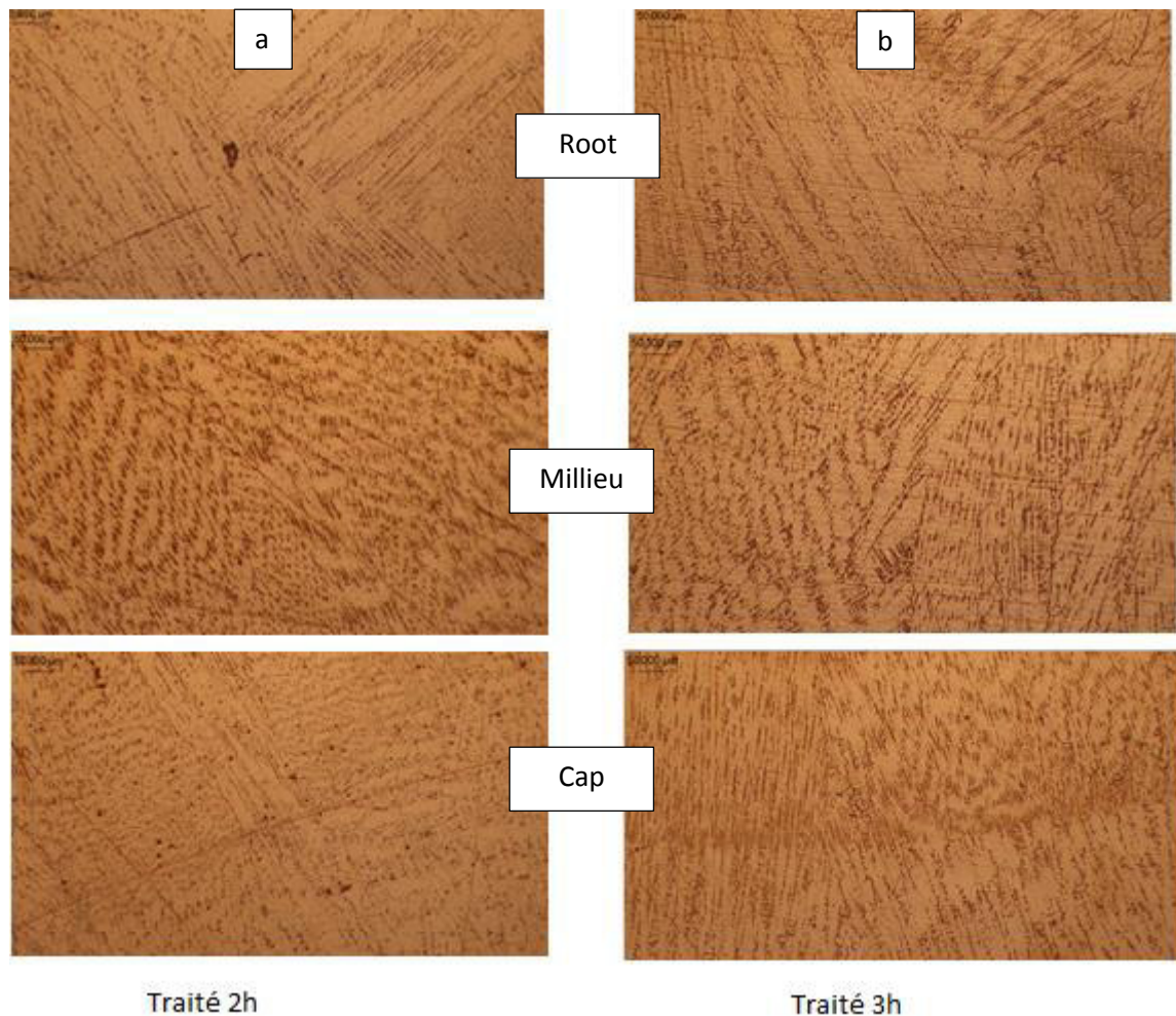
Figure 3.10 : Micrographie optique de la zone fondue après traitement (a. 2h attaqué 60s, b. 3h attaqué 90s)
