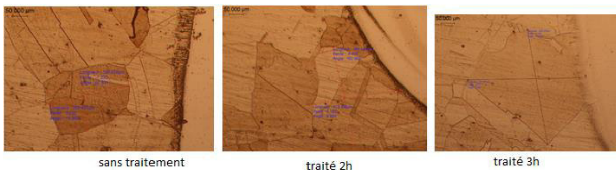
Figure 3.9 : Micrographie optique de taille de grain dans la ZAT (a. non traité attaqué 40s, b. traité 2h attaqué 45s, c. traité 3h attaqué 50s).
