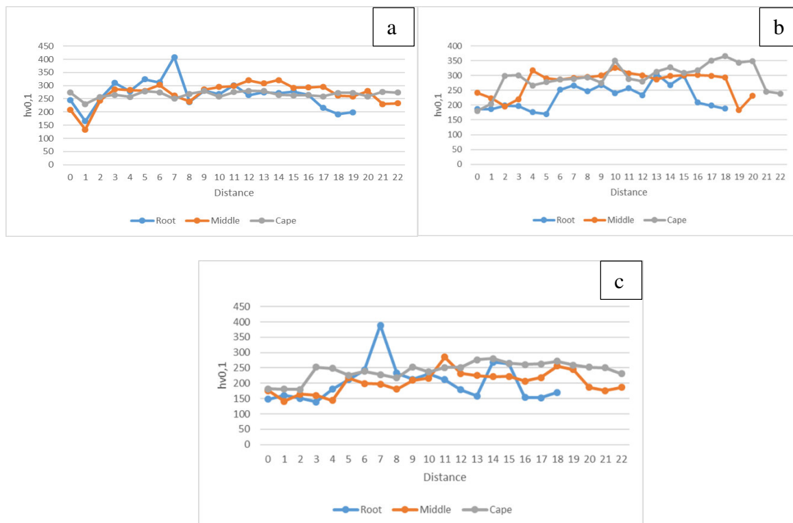
Figure 3.11 : Evaluation de la dureté dans les trois zones (a. avant traitement, b. traité 2h, c. traité 3h).
