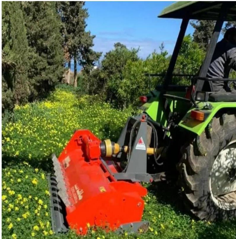
Figure II. 11 : Utilisation de broyeur à marteaux
