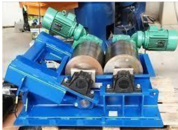
Figure II.8 : broyeur à cylindres
