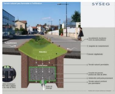
Figure 91: Schéma de récupération des eaux pluviales.
