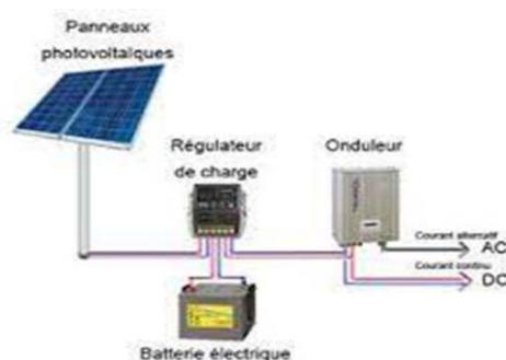
**Figure 19: Le système photovoltaïque**
