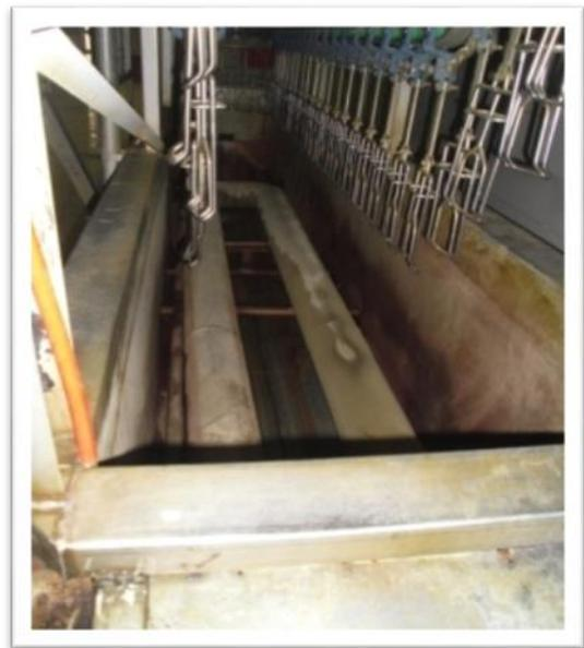
**Figure 4** : Bac où les poulets sont échaudés.
