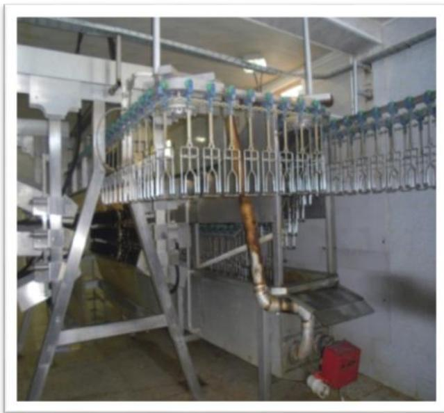
**Figure 3** : Machine d'échaudage où les poulets sont suspendus.
