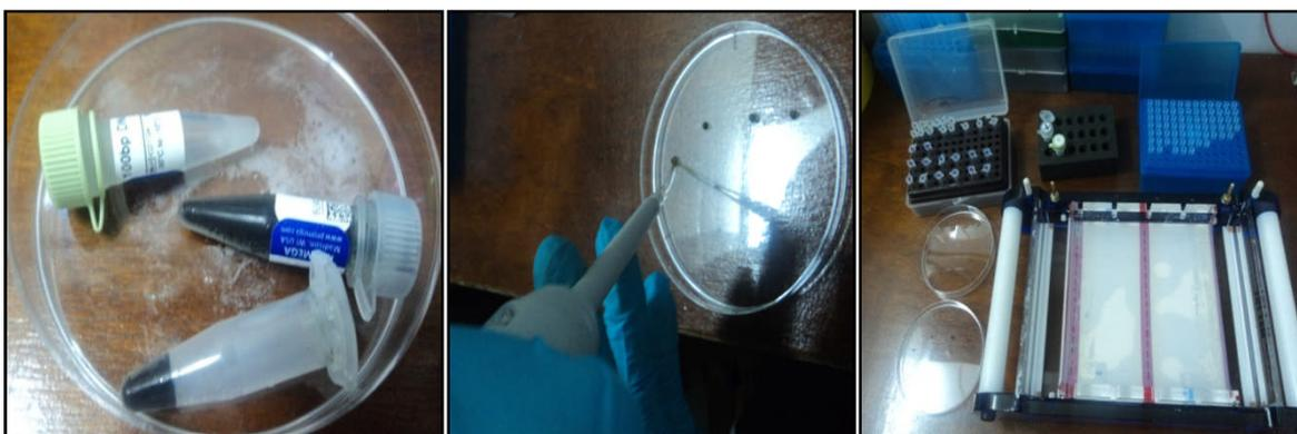
**Figure 29:** Dépôt des amplifiats après coloration dans le gel d'agarose.
