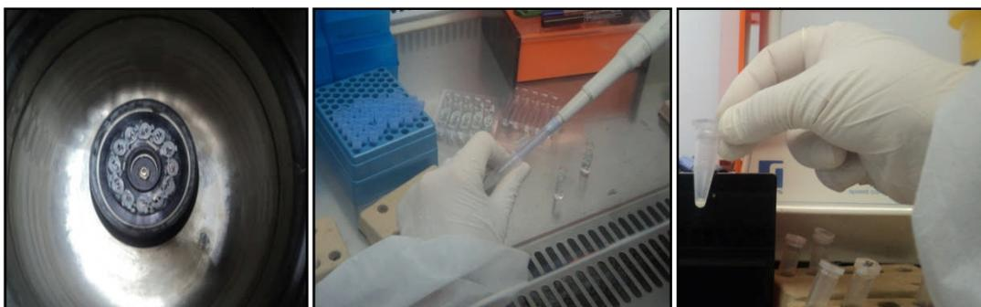
**Figure 21:** Centrifugation des eppendorf et récupération du culot.
