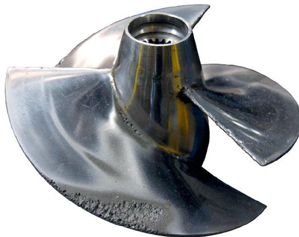
Figure 2. 10: phénomène de cavitation
