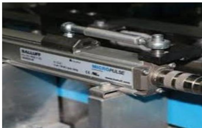
*Figure 2.5 Le transducteur Micropulse.*
