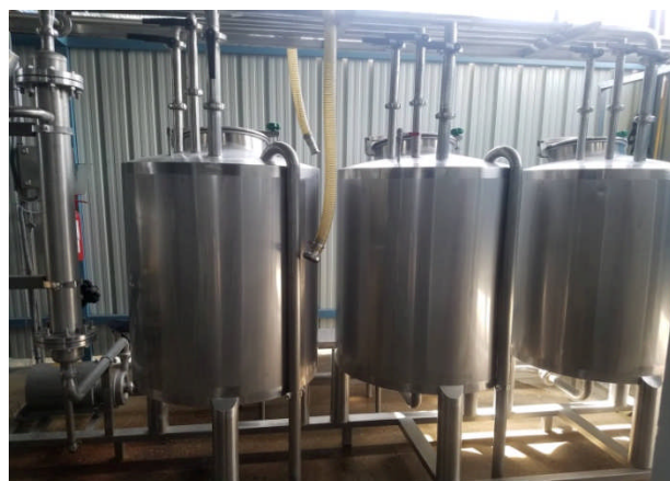
Figure 19 : Station de CIP (Bac de la soude caustique, acide nitrique et eau chaude)
