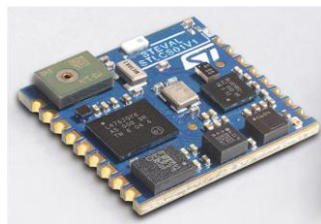
Figure 2-3 Exemple d'une centrale inertielle à base de MEMS
