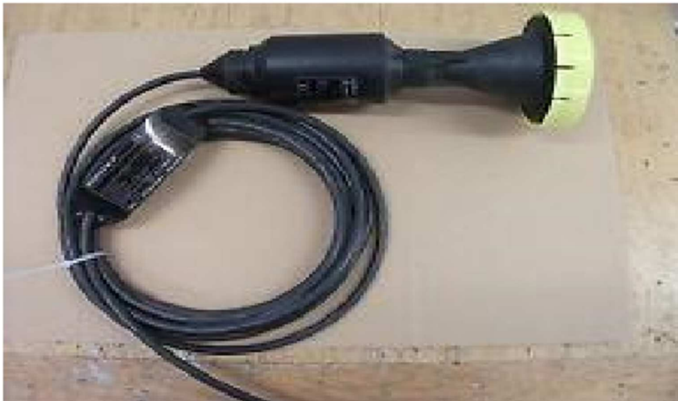
Figure 3.4 : sondes de niveau analogique piézorésistif [6].
