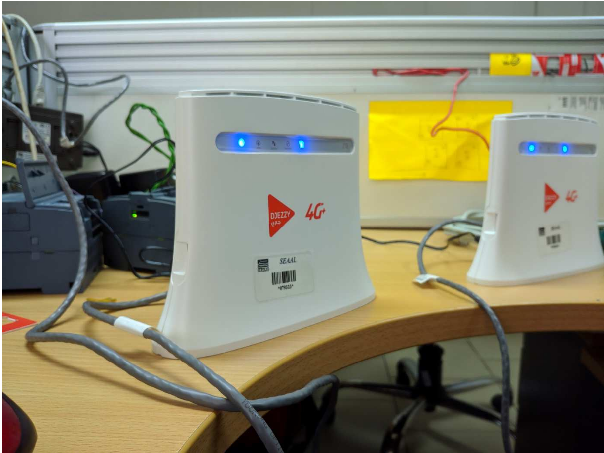
Figure 4.11 : Routeurs de communication.
