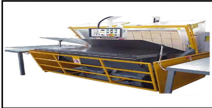
Figure II.5 : Platines de découpe (Rabolini)
