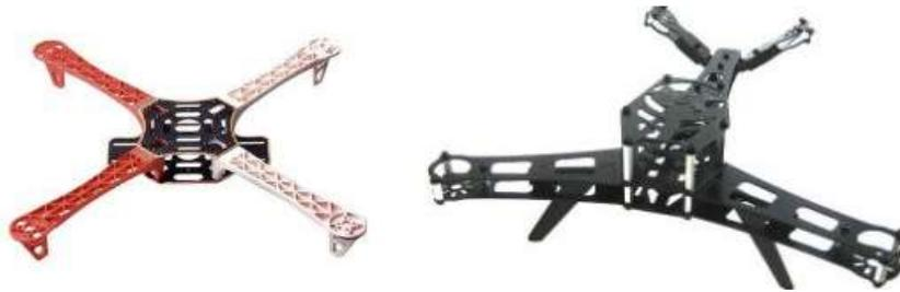
Figure 1- 12 : Structure de drone multi-rotors[19]
