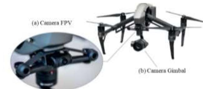
Figure 1- 25 : Les camera de drone[24]
