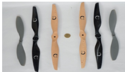
Figure 1.10: Hélices horaires en carbone (noires), hêtre (beiges) ou nylon (grises)
