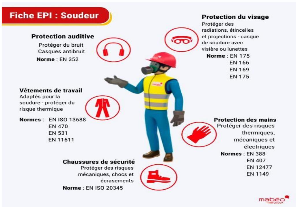
Figure.1.16. Elément de protection individuel pour le soudeur
