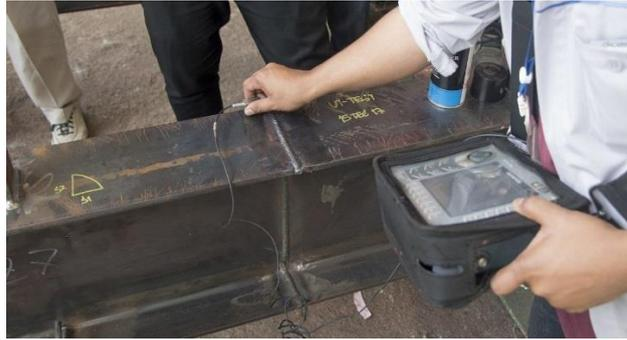
Figure.1.15. Contrôle par ultrasons
