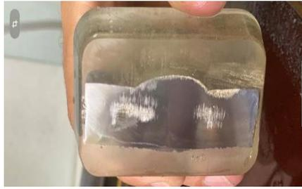
Figure III.18. Echantillon soudé en coupe transversale enrobé froid
