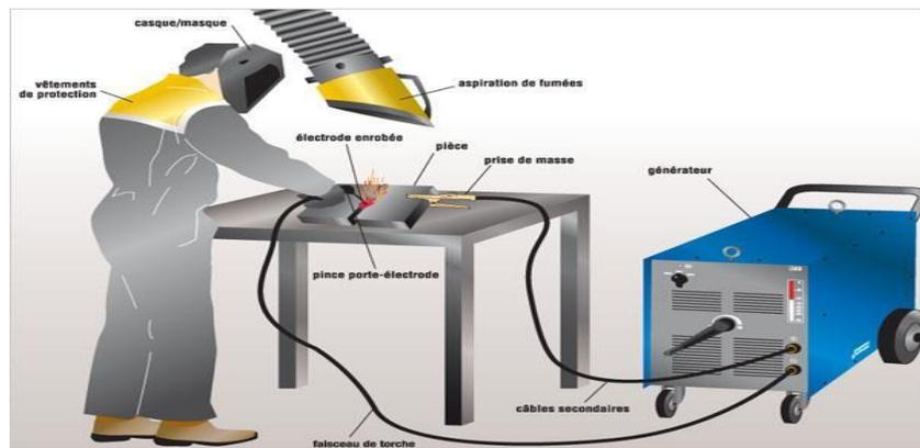
Figure.1.3. Schéma d'installation pour soudage manuel SMAW
