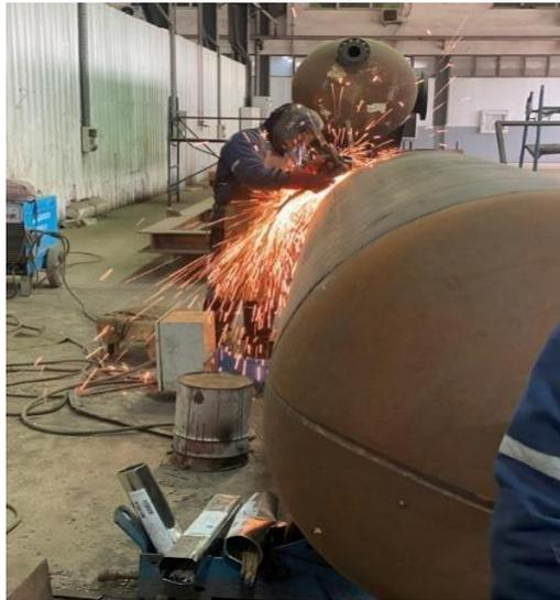
**Figure 2.8.** Soudage d'un réservoir sous pression par soudage SMAW
