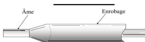
Figure.1.5. Electrode enrobée
