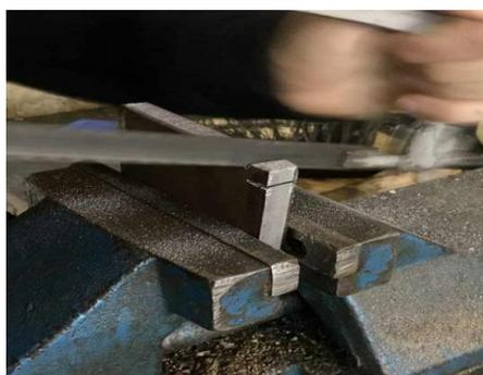
Figure III.14. Découpage par la scie manuel
