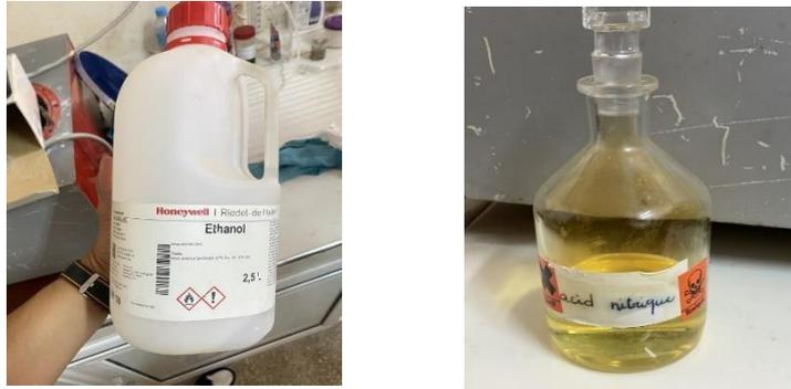
Figure III.21. Préparation du Nital à partir d'acide nitrique et l'éthanol
