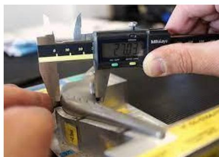
Figure.1.12. Contrôle dimensionnel
