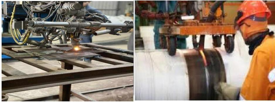
Figure.1.8. Principe de soudage à l'arc submergé.
