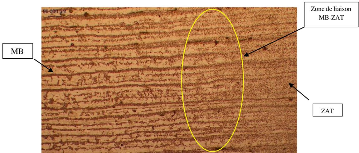
Figure IV.7. Micrographie optique de zone de liaison ZL (ZAT+MB)
