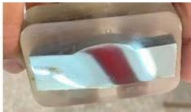
Figure III.20. Échantillon soudé après polissage
