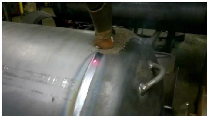
**Figure 2.9.**Soudage de passe finition par soudage automatique SAW
