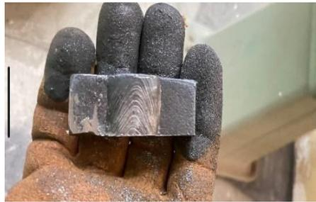
Figure III.15. Echantillon soudé après découpage
