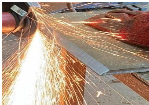
Figure. III.7. Meulage du chanfrein des éprouvettes
