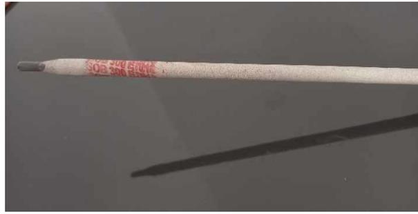
Figure.III.3. Electrode enrobée E 7018
