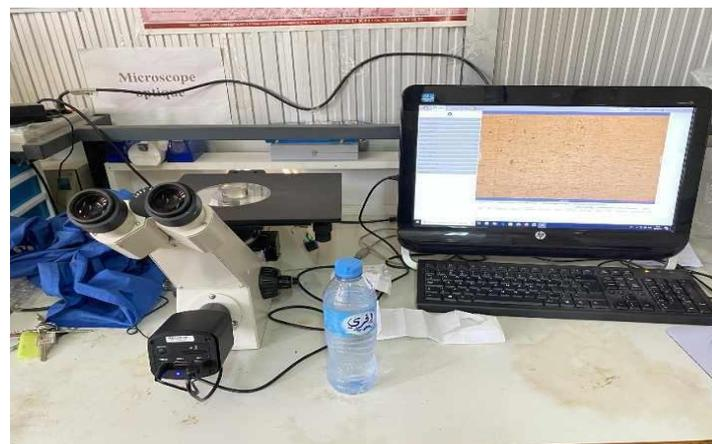
Figure III.22. Microscope optique utilisé
