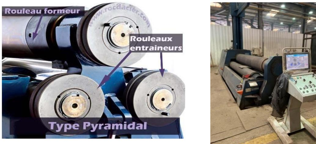
**Figure 2.7.** Rouleuse pyramidale
