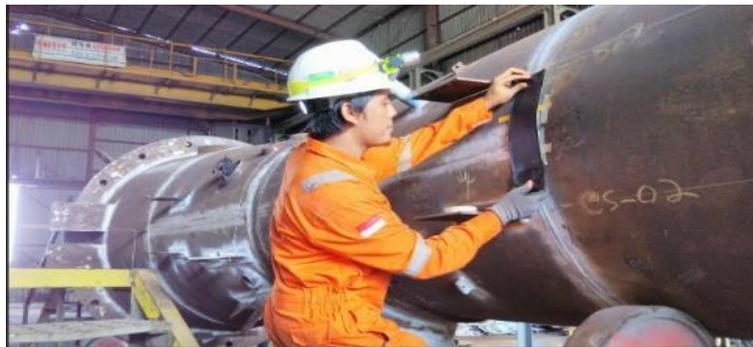
**Figure 2.12.** Contrôle par radiographie
