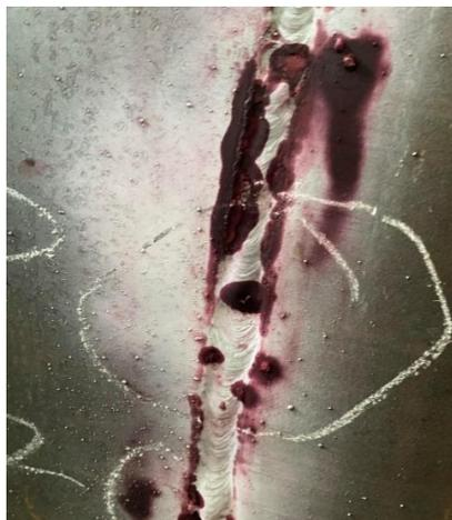
**Figure 2.11.** Contrôle par ressuage
