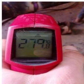
Figure III.9. Thermomètre infrarouge
