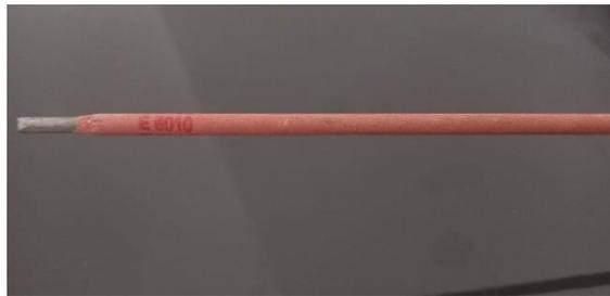
Figure.III.2. Electrode enrobée E6010
