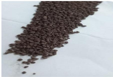
Figure. III.5. Particules de flux solide
