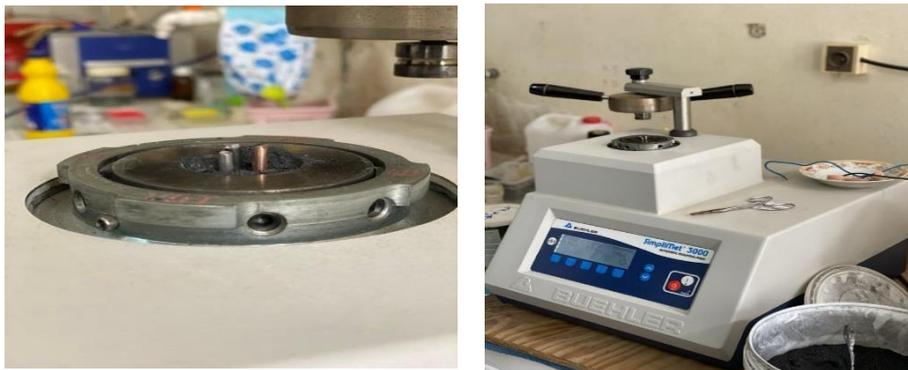
Figure III.16. Machine d'enrobage à chaud
