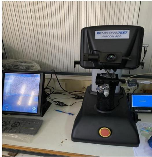
Figure III.23. D'uromètre INNOVATEST FLACON 400.
