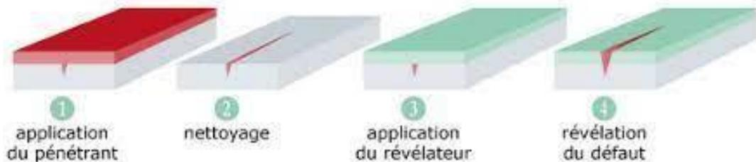
Figure.1.13. Méthodologie de contrôle par ressuage
