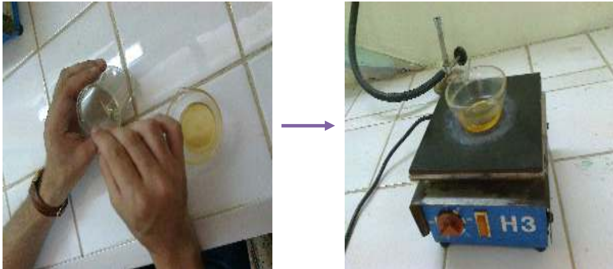
1 : Nettoyage et dégraissage par Chloral PhénoI 2 : Chauffer le contenu pendant 3 à 4 minutes
