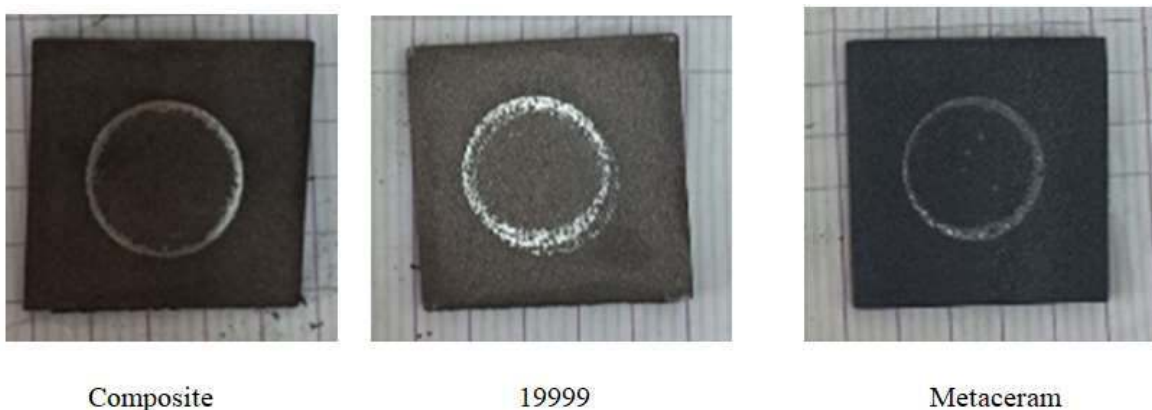
Figure 3.8 : Aspects des surfaces des revêtements après l'essai d'usure pion sur disque.
