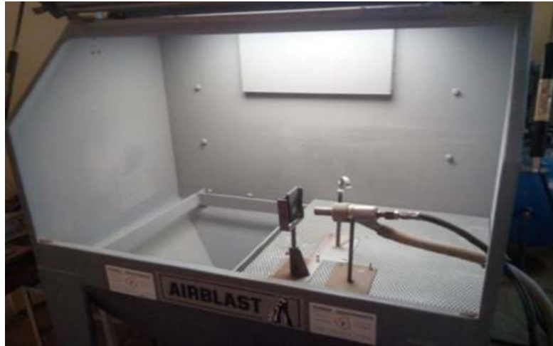
Figure 2.11 : Montage expérimental pour l'essai d'érosion.
