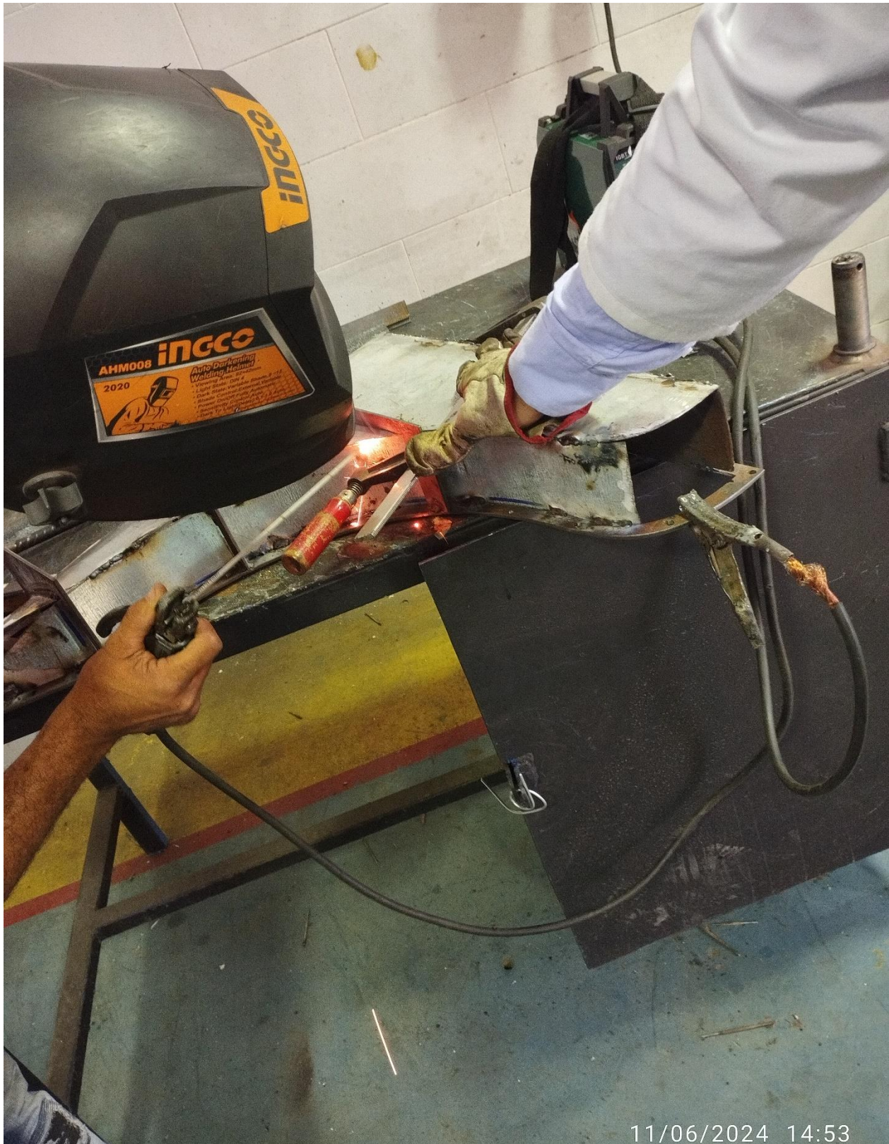
Figure 66 : pointage de tôle 02 sur le moule
