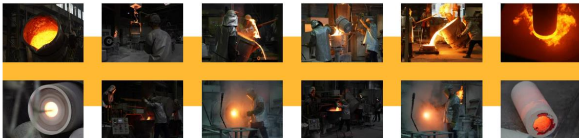
Figure 5 : Moulage par centrifugation, by LBI foundries société
