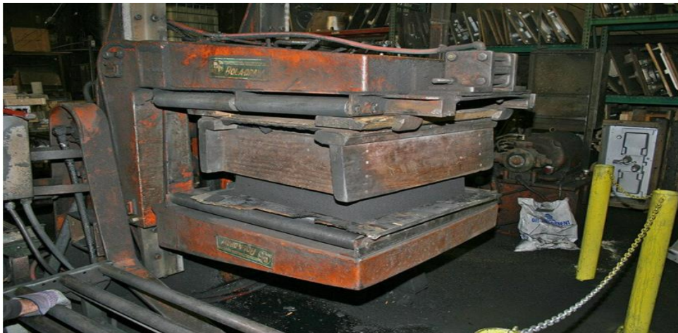
Figure 2 : châssis supérieur extrait de la boîte de moulage OKFoundry,CC BY 2.0,via Flickr
