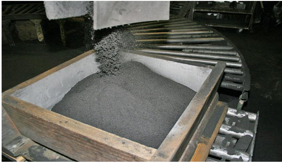
Figure 1 : remplissage de la boîte de moulage OKFoundry,CC BY 2.0,via Flickr
