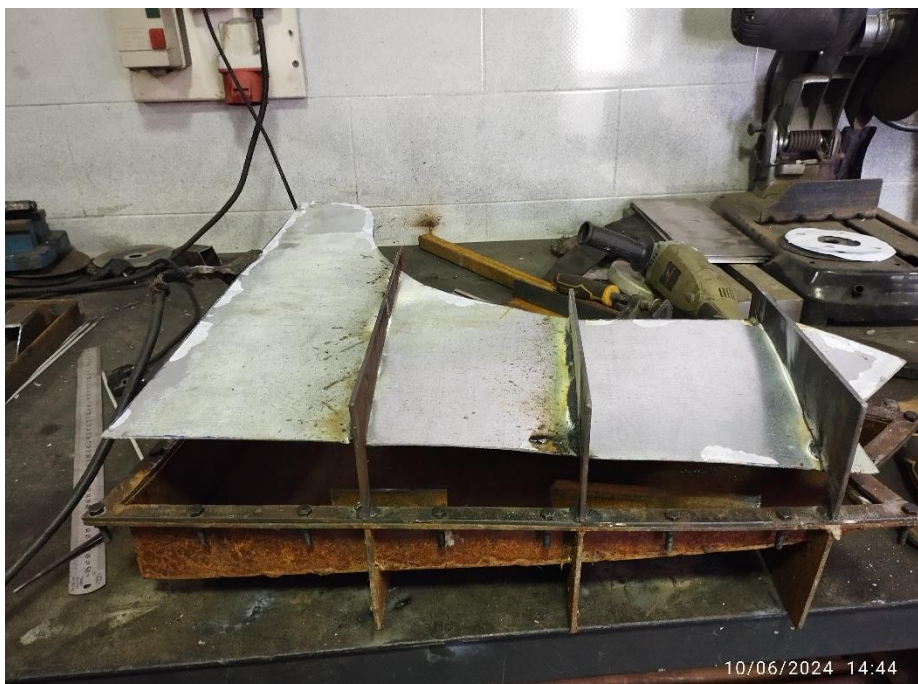
Figure 65 : finalisation de tôle 01 sur le moule
