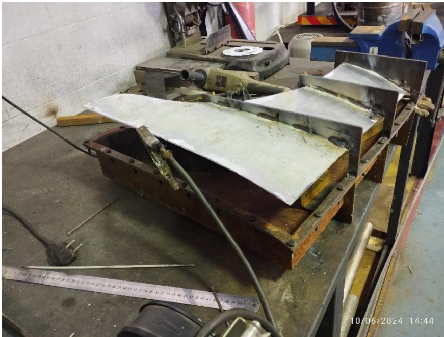
Figure 64 : pointage avec soudage par baguette de tôle 01 sur le moule
