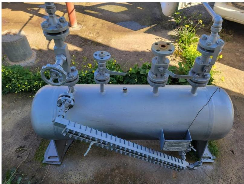
Figure (1.9) Odoriseur de poste de détente chiffa
