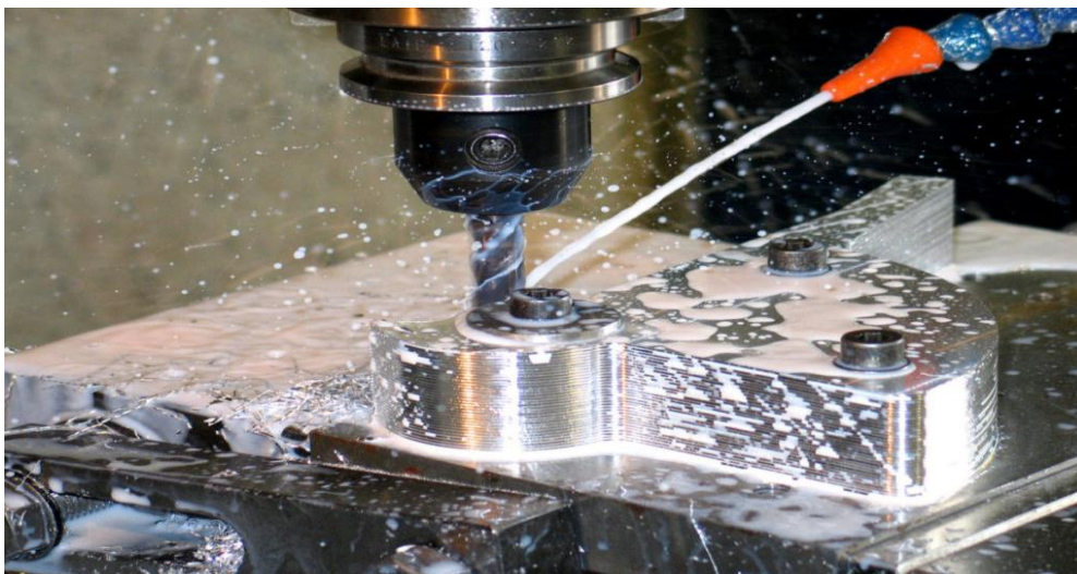
Figure IV.2 : procédé de fraisage
