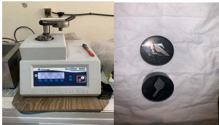
Figure IV.7 : Enrober les échantillons.
