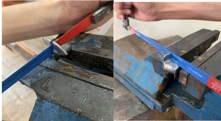
Figure IV.6 : Découpe les échantillons.
