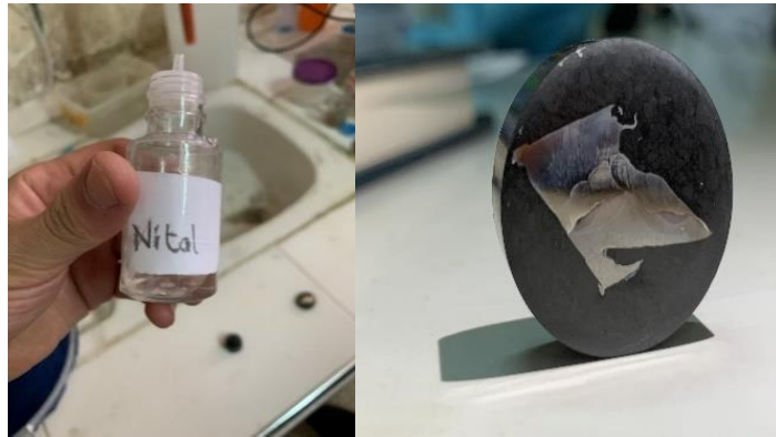
Figure IV.9: Attaque l'échantillon par Nital.
