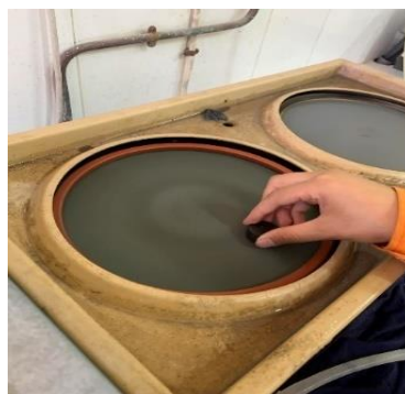
Figure IV.8 : Polissage de l'échantillon.
