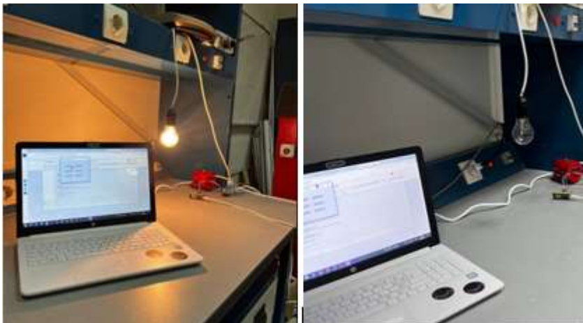
Figure 3.24: Allumer et éteindre la lampe avec esp32.
