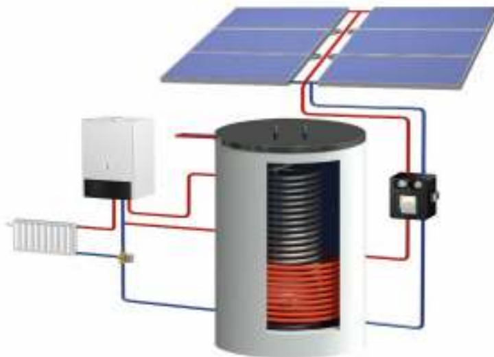
Figure1. 7. chauffage centrale d'énergie solaire [17]
