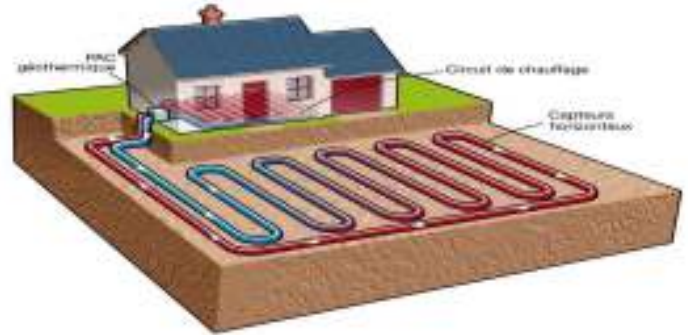
Figure1. 12.Pompe à chaleur à tube horizontal [20]
