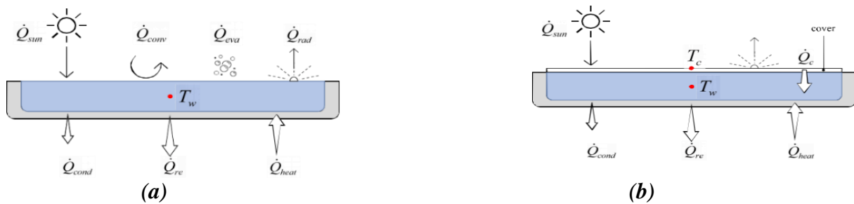
Figure 2.2: Bilan énergétique d'une piscine intérieure : (a) découverte ; (b) couverte
