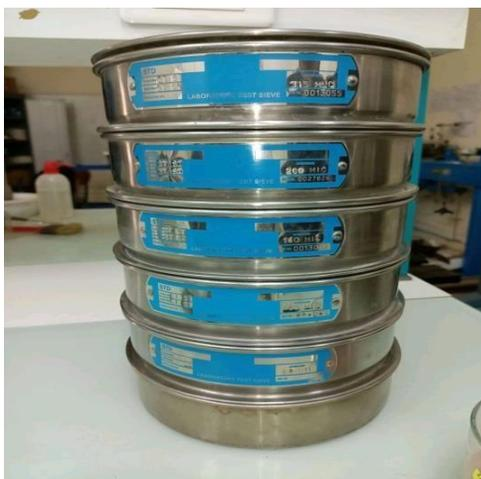
**Figure A. 9** : Série des tamis pour le tamiseur.
