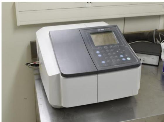
**Figure A.1** : Spectrophotomètre UV VISIBLE.
