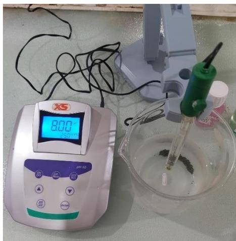
Figure A.12 : Mesure de pH d'argile.
