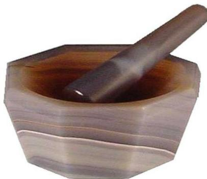
Figure A.4 : Mortier et pilon en agate.
