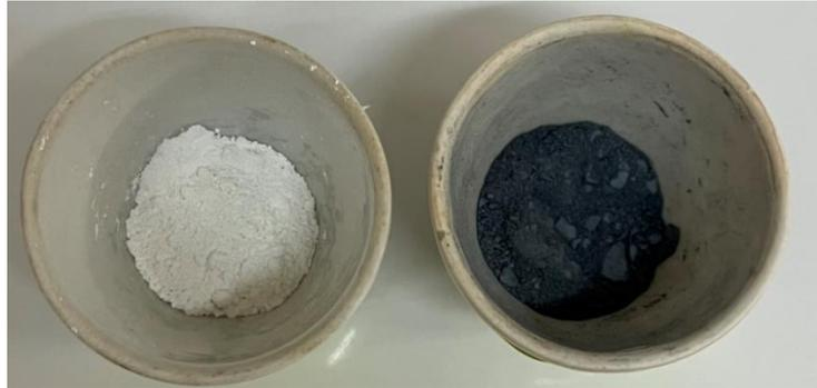
**Figure 19:** Calcination de deux oxydes métalliques.
