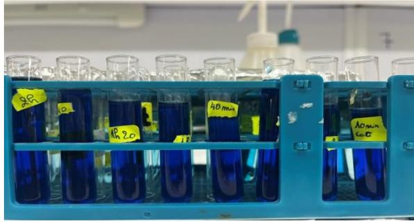
**Figure 29:** Résultat de la photocatalyse après 4h en utilisant une lampe LED.
