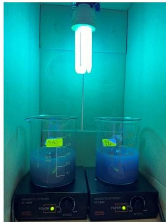
**Figure 30:** Montage en utilisant une lampe UVa.
