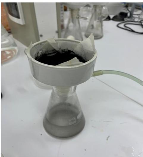
Figure 15: Rinçage du bio charbon par HCl.
