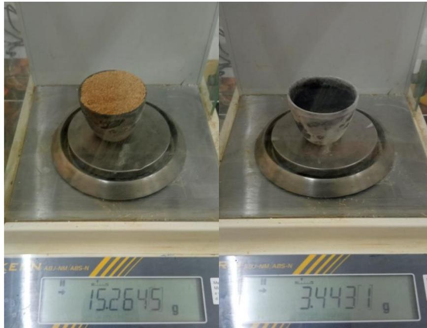
**Figure 13:** La carbonisation de washingtonia séchés dans un four à moufle à (T=700°C pendant 180 minutes).
