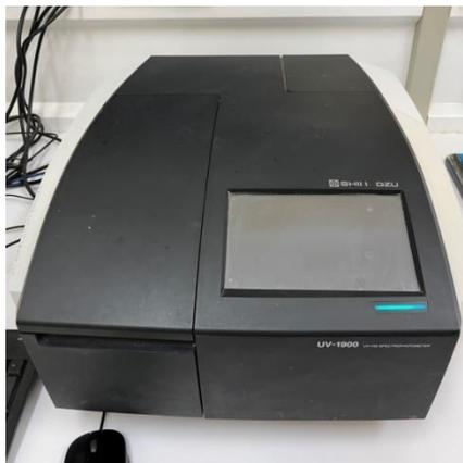
**Figure 10:** Spectrophotomètre UV-Visible.
