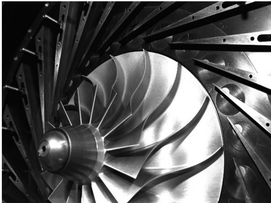
Figure III.2. Étage du compresseur centrifuge - paroi frontale enlevée. [1].
