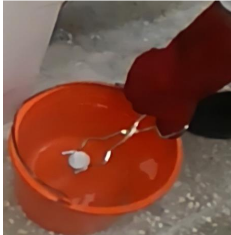
Figure 49: trempe l'échantillons d'alliages
