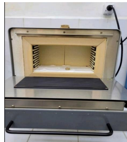
Figure 43: Le four utilisé pour la fusion
