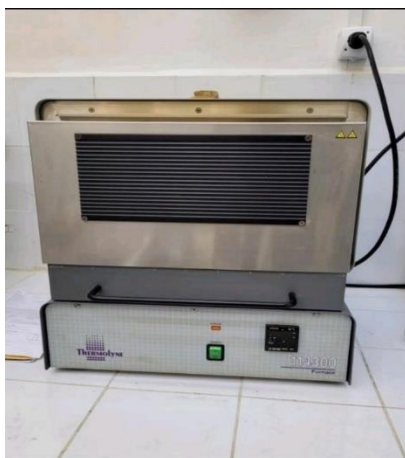
Figure 43: Le four utilisé pour la fusion
