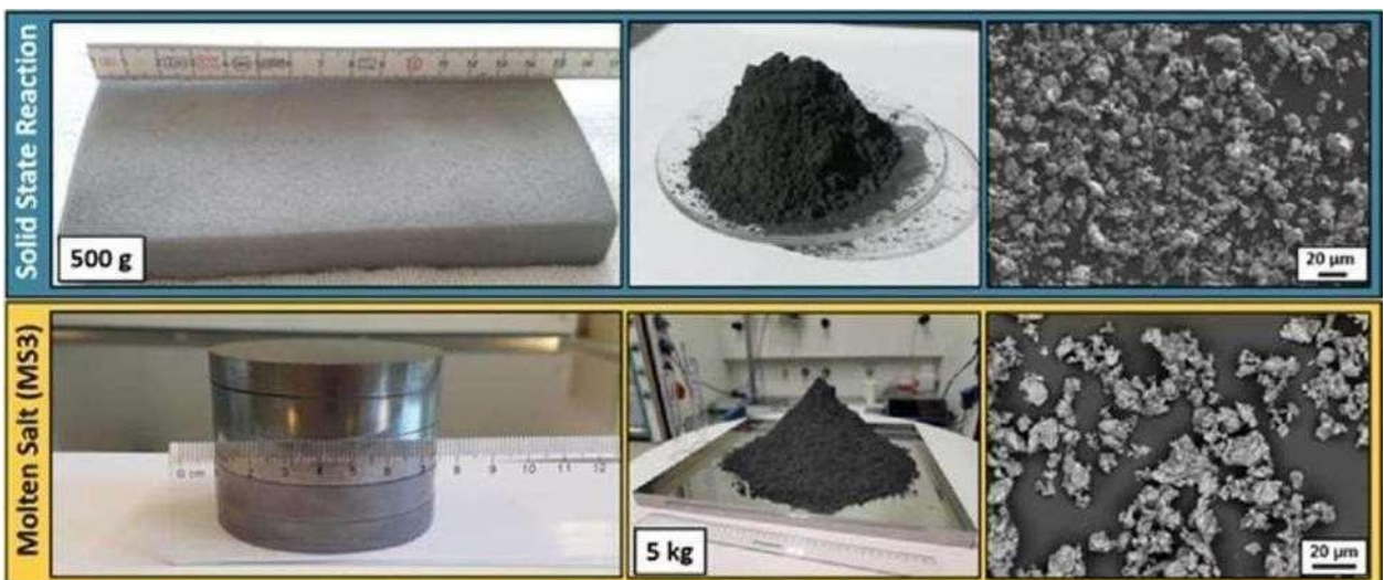
Figure I. 8: Photographies et images MEB de la réaction et synthèse à l'état solide pour 500g de Cr 2 AlC protégé de sel fondu [18].
