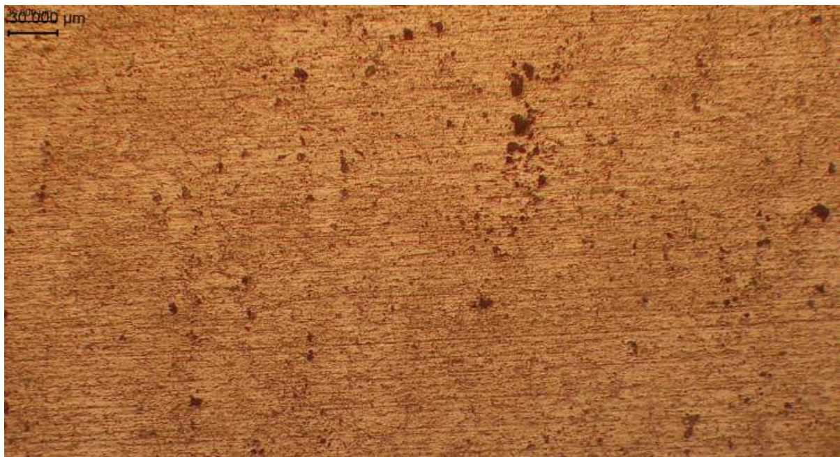
Figure V.12 : Microstructure optique de l'alliage vieilli 3h à 150°C avec attaque chimique x100 et x200
