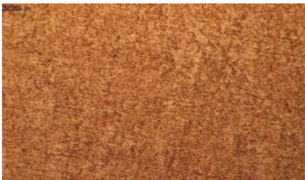
Figure V.11 : Microstructure optique de l'alliage vieilli 3h à 150°C sans attaque chimique x100 et x200
