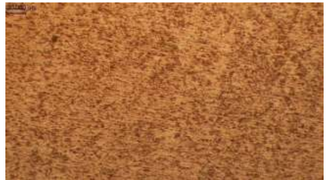
Figure V.11 : Microstructure optique de l'alliage vieilli 3h à 150°C sans attaque chimique x100 et x200
