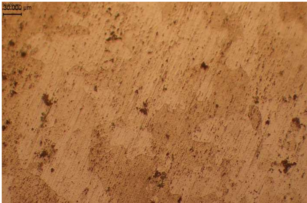
Figure V.8 : Microstructure optique de l'alliage vieilli 1h à 150°C avec attaque chimique
