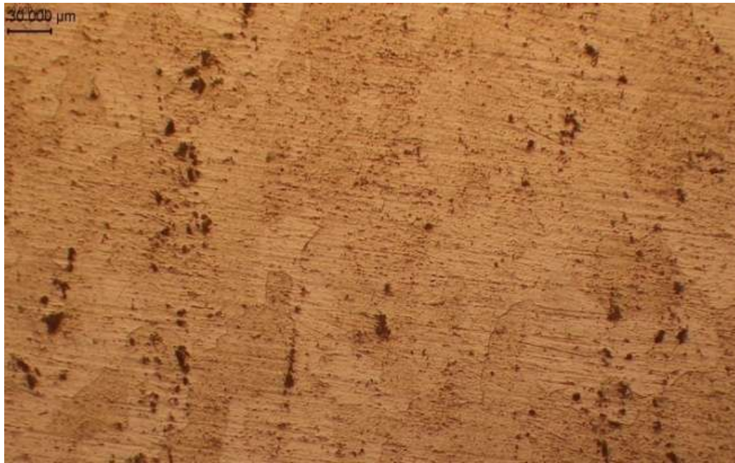
Figure V.10 : Microstructure optique de l'alliage vieilli 2h à 150°C avec attaque chimique (x100 et x200)
