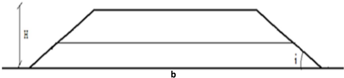
Figure 1. 4: Caractéristiques géométrique d'un remblai.
