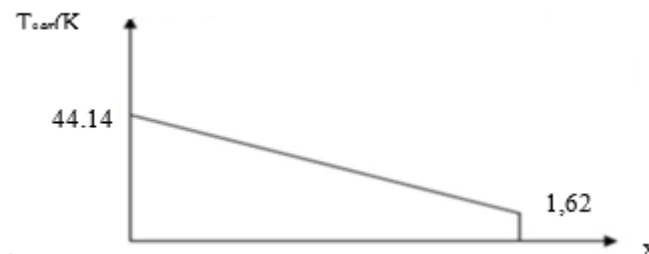
Figure III. 16: Diagramme de l'effort tranchant à ELS.
