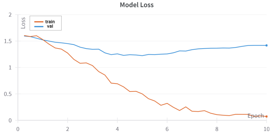
FIGURE 3.4 – Le graphe des pertes avec 10 époques utilisant DistilBERT sur des tweets bruts.
