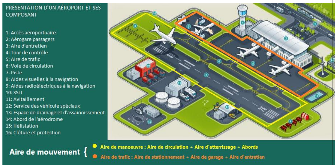
Figure 1 : Les Composantes d'un aérodrome [18].
