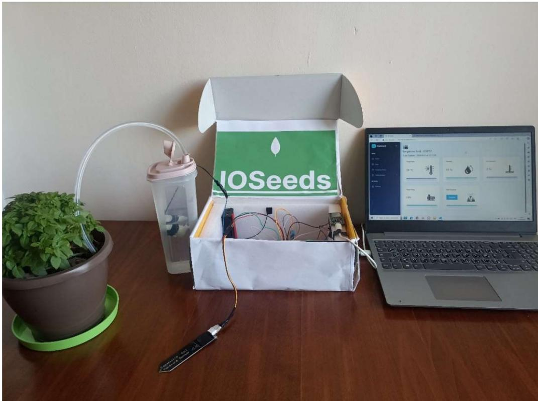
Figure 43 : fonctionnement du système avec pompe activé
