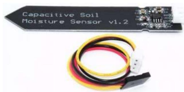
Figure 23 : Capteur capacitif d'humidité du sol [26]
