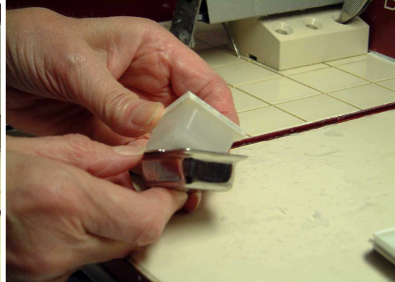
Démoulage, après refroidissement
