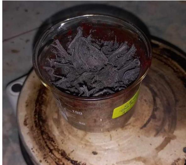
*Figure 40: CFO après l'auto-combustion.*
