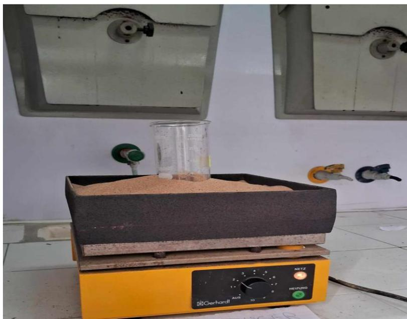
**Figure 31: Bain de sable (autocombustion).**
