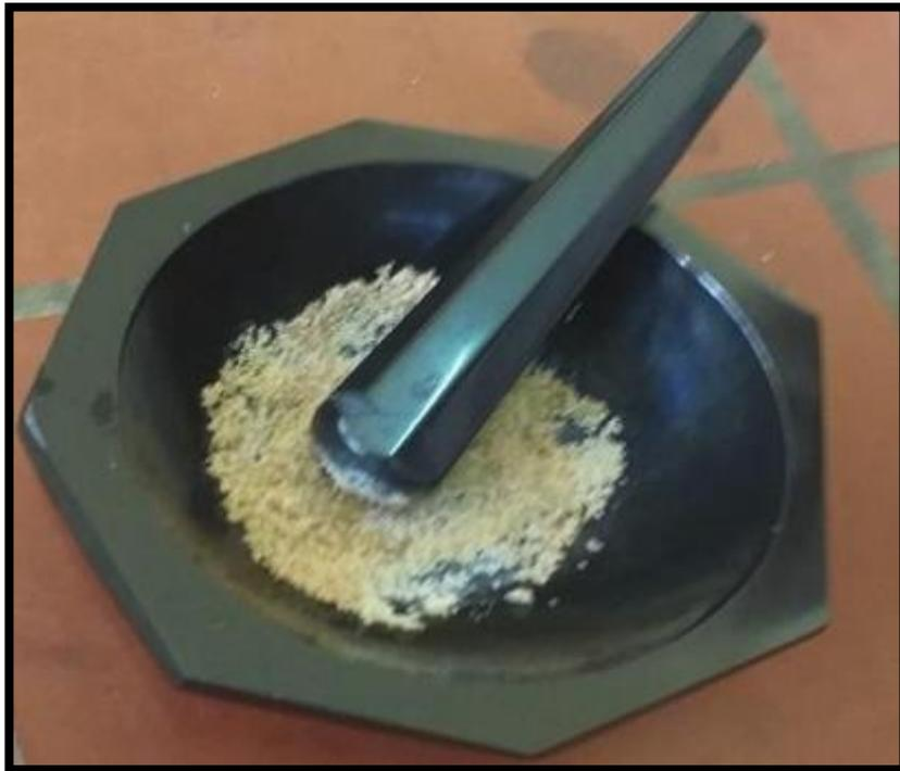
*Figure 11 : Mortier en agate.*
