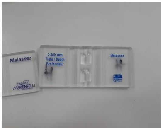
**Figure 11 : Cellules de Malassez (ou Hématimètre de Malassez)**
