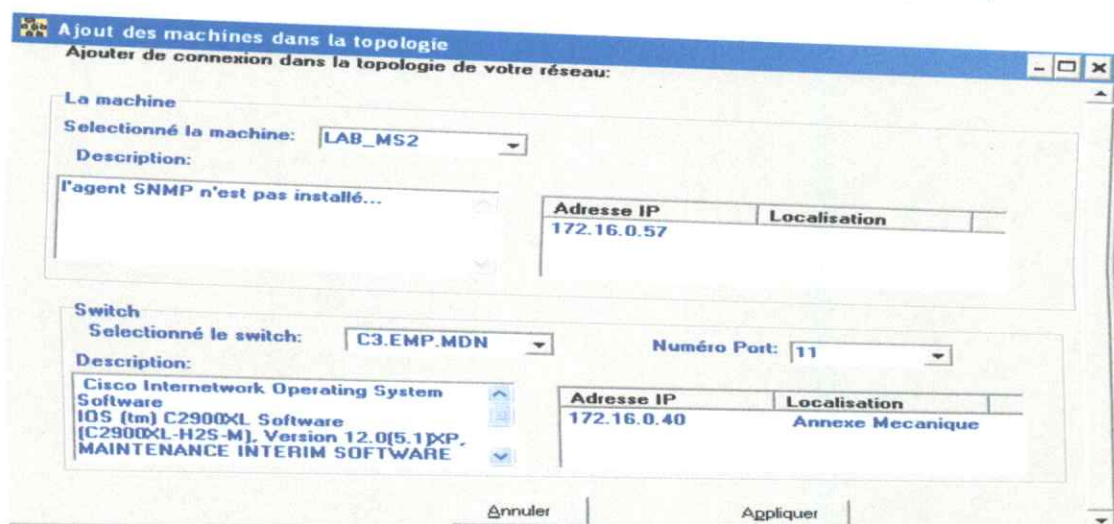
Fig V-12 : Fenêtre « L'ajout d'une machine »
